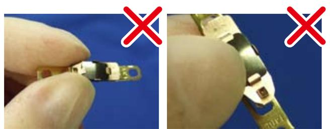
请千万不要采取触及接点,双金属片,爪及可动接点板的手持方法。
