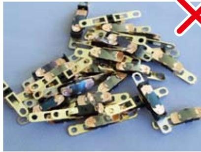
如杂乱地放在工作台上,接点和端子会绞在一起。因此,恐会造成接点压力减少,接点处于开启状态,最终产品不动作。
