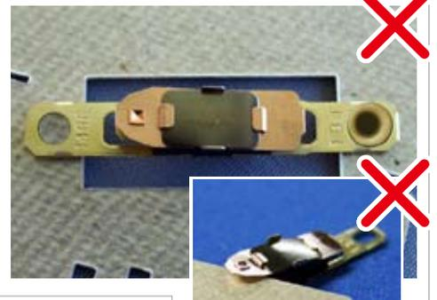
第一步 首先将金属器具插入「孔(圆形状一侧)」中,箍紧固定。
